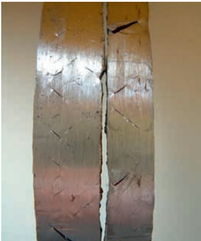
Abbildung 26: gebogene Prüfstücke mit aufgeweiteten Rissen
