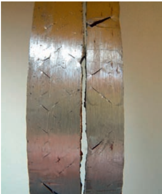
Abbildung 26: gebogene Prüfstücke mit aufgeweiteten Rissen
